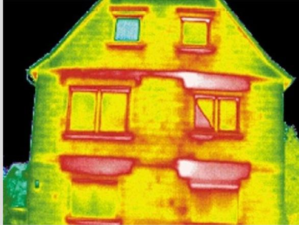
Anhand dieses Wärmebildes wird klar, wo die Wärme entweicht. (rote Bereiche = sehr hoher Wärmeverlust). Es sind die schlecht, bis gar nicht gedämmten Rollladenkästen von vor den 70er bis 90er Jahre, die für hohen Wärmeverlust verantwortlich sind.
